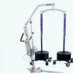
aufgehängter Zustand (Test bei einem 185 kg Lifter)
